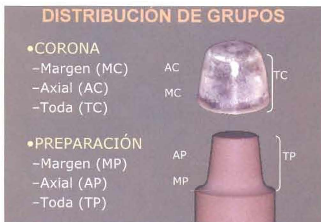
Figura 9. Probeta y corona utilizada para el estudio de la distribución de cemento en función del lugar de aplicación del mismo. Se muestran las 6 distintas localizaciones en las que era aplicado el cemento en función del grupo experimental al que pertenecían
